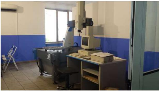
Per garantire al Cliente un prodotto di qualità e di elevata precisione siamo dotati di laboratorio attrezzato con macchina di misura tridimensionale che ci permette di effettuare controlli accurati sia prima che durante e dopo la lavorazione dei pezzi.
